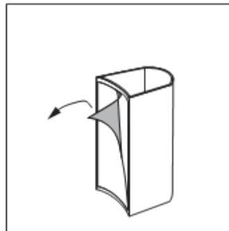
Drücken Sie nun die Klebefläche des Halters für die Applikationsspritze (große Öffnung nach oben) an den unteren Teil der Flasche. Die gereinigte Applikationsspritze kann nun in den Halter für die Applikationsspritze hineinsteckt werden.
