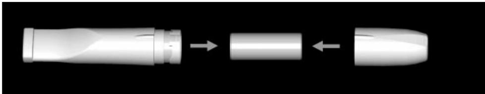
3. Durch Zusammenstecken der beiden Teile des Mundstücks wird das Siegel auf beiden Seiten der Patrone durchstoßen. Beim Zusammenstecken achten Sie bitte darauf, dass die Markierungen übereinstimmen.
